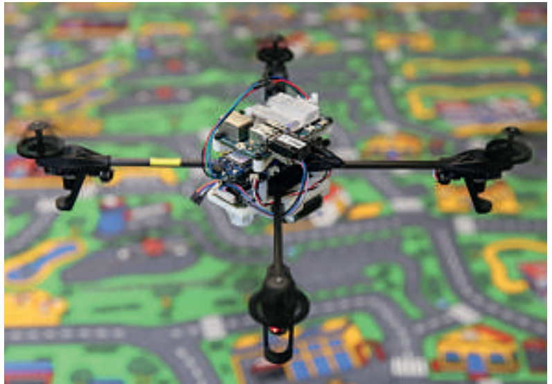
Ein Smartphone-Computer dient der Drohne als Steuerungseinheit.
