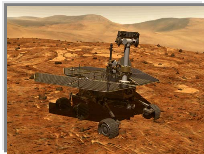
Il rover Spirit costruito dalla NASA. Si avvale di un sistema di visione complesso, composto da 9 telecamere, di cui 4 coppie stereoscopiche per l'"obstacle avoidance" e l'autolocalizzazione
