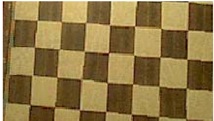
Figura 3.17 Ancora alcuni dettagli delle immagini rettificate, appositamente ingrandite per evidenziare l'effetto di zigrinatura dei tratti rettilinei (o degli angoli della scacchiera) causata dall'interpolazione di ordine zero. È evidente la notevole perdita di qualità rispetto alle immagini di origine.
