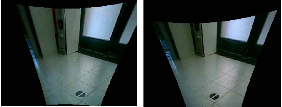
Figura 5.11 Immagini rettificate con un angolo di inversione prospettica ancora troppo piccolo rispetto a quello reale. Come si vede, infatti, le linee del pavimento convergono a due punti di fuga e i landmark appaiono ancora ellittici. Si osservi inoltre come l'inversione prospettica induca anche una deformazione omografica delle immagini.
